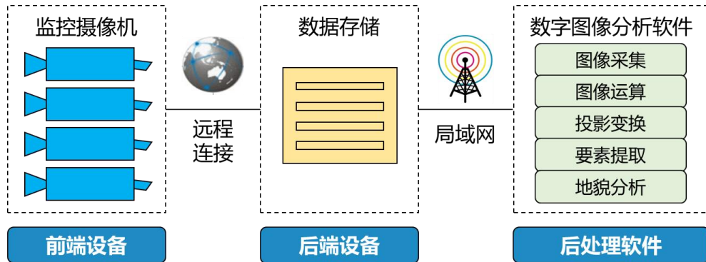
图 1 海滩岸基数字影像监测站点架构图
